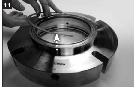
Burç takımlı salmastralar için: Takma halkasını salmastra bileziğinden çıkarın ve atın.
